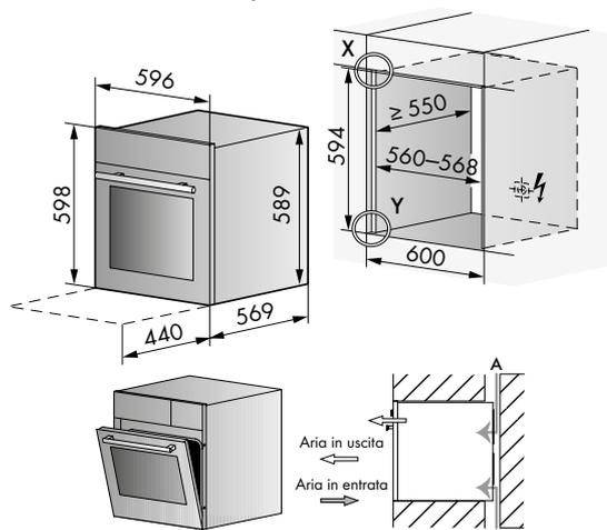
**Attenzione:** per garantire una buona ventilazione la nicchia deve essere provvista di un passaggio d'aria, posizione A e B compresa tra  $\geq 80$  e  $\leq 850$  cm<sup>2</sup>
